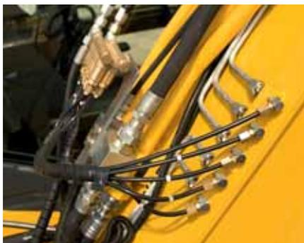
Système de graissage automatique
