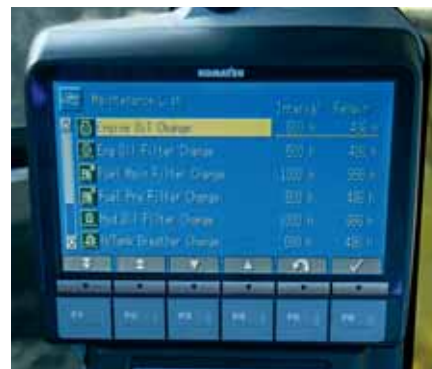
L'écran LCD indique les anomalies et les moments de remplacement.
