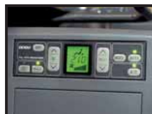
Climatisation à régulations de température
