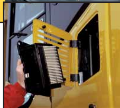
Filtre à air extérieur
