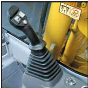
Leviers avec boutons de commande proportionnels pour les accessoires
