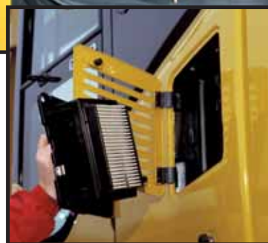
Filtere à air extérieur
