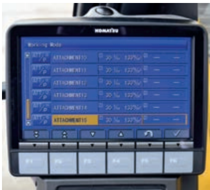
Contrôle des équipements intégré Komatsu (KIAC) offre jusqu'à 15 présélections d'outils pour le débit et la pression d'huile
