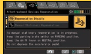
Écran de régénération du système de traitement des gaz d'échappement pour le filtre à particules diesel Komatsu (KDPF)
