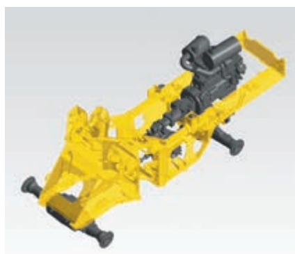
Châssis robuste et résistant à la torsion
