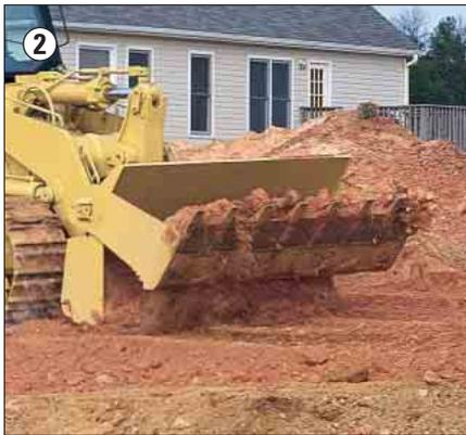
**2 Godets tous-travaux.** Le godet tous-travaux (MP) est prévu pour un vaste champ d'applications telles que chargement, décapage, défrichage, refoulement, nettoyage des gravats et fin réglage. Mâchoire du godet à commande hydraulique pour saisir des grumes ou manutentionner d'autres matériaux difficiles à saisir.
