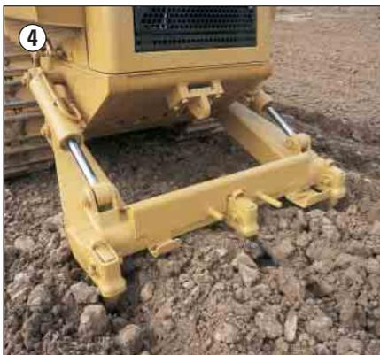
**4 Ripper-scarificateur.** Le ripper-scarificateur augmente encore la polyvalence de la machine. Du type articulé à trois dents, monté par deux axes de part et d'autre du bâti principal. Relevage et abaissement commandés par deux vérins largement espacés. Timonerie à six axes ne requérant aucun graissage.
