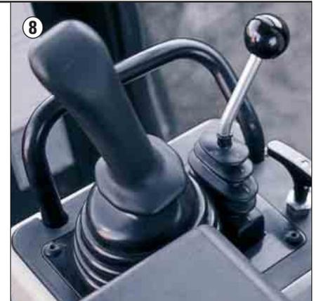
**8 Commandes pilotées.** Commandes d'équipement pilotées pour faciliter la conduite et augmenter la productivité. Choix entre des commandes pilotées à un seul levier (de série) ou à deux leviers (en option) pour le levage et le vidage du godet. Limiteur de levage et retour à l'angle d'attaque automatiques et réglables permettant au conducteur de se concentrer sur le positionnement de la machine, d'où une productivité supérieure.
