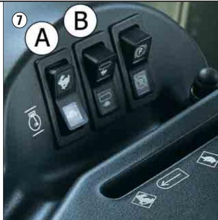
**6 Commandes de transmission hydrostatique.** Les commandes de transmission hydrostatique autorisent des changements rapides de vitesse et de sens de marche à l'aide d'un seul levier pour une maniabilité optimale. Direction par pédales procurant une commande précise de chacune des chaînes ainsi que leur mise en contre-rotation. La pédale de frein complète le freinage hydraulique dynamique assuré par la transmission hydrostatique.
