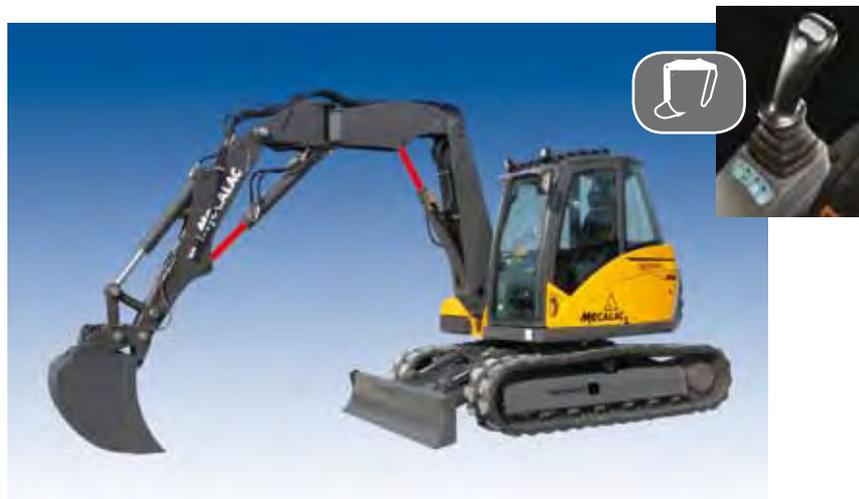
**COUPLAGE DE VÉRINS** : Maniement de l'équipement en trois parties sans l'usage de pédales grâce au couplage de vérins (brevet Mecalac).
