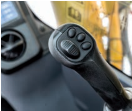
Commandes pratiques, ergonomiques et précises: leviers à bouton de commande proportionnel pour les accessoires
